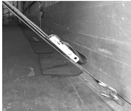
Abb. 21: Spannschloss im geschlossenen (gesicherten) Zustand
