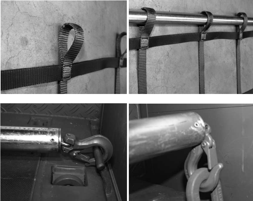
Abb. 4-7: Die Sperrstange dient zur Unterstützung der formschlüssigen Ladungssicherung. Um eine optimale Funktion zu gewährleisten, ist die Ladeeinheit direkt an die Sperrstange anzulegen. Eine flächige Belastung ist zu gewährleisten.
