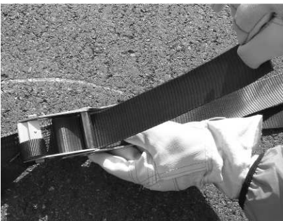
Abb. 16-17: Schnellspanner für den Einsatz vorbereiten
