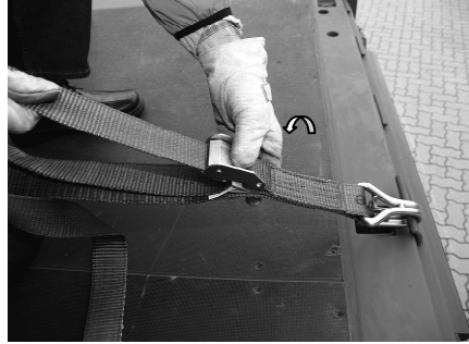
Abb. 9: Zum Lösen Hebel betätigen
