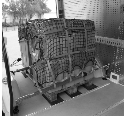
Abb. 16: Verankerung der DoVario-Teleskop- stange in den Zurrschienen.
