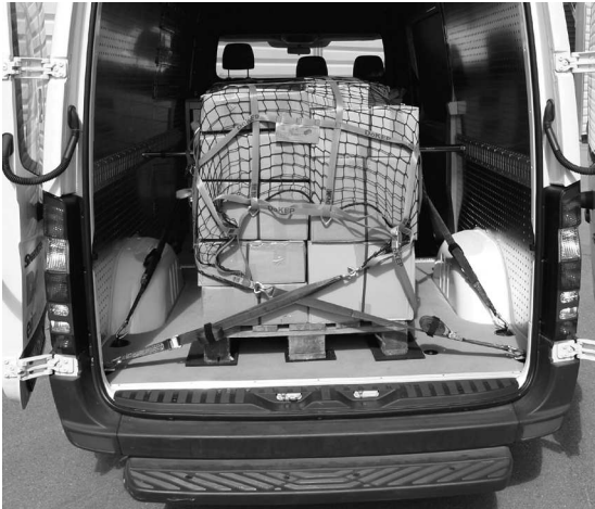
Abb. 17: Verspannung des Netzes mittels Schnellspannern.
