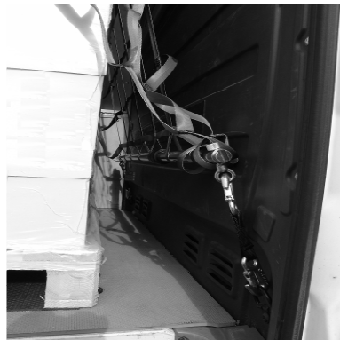
Abb. 6: Die DoVario-Teleskopstange im Einsatz.
