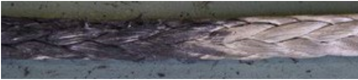
Abb. 16: Beispiel für Schäden durch chemischen Einfluss
