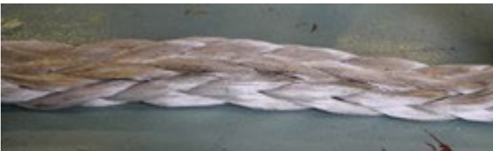
Abb. 11: Beispiel für eine Verdichtung des Anschlagseils
