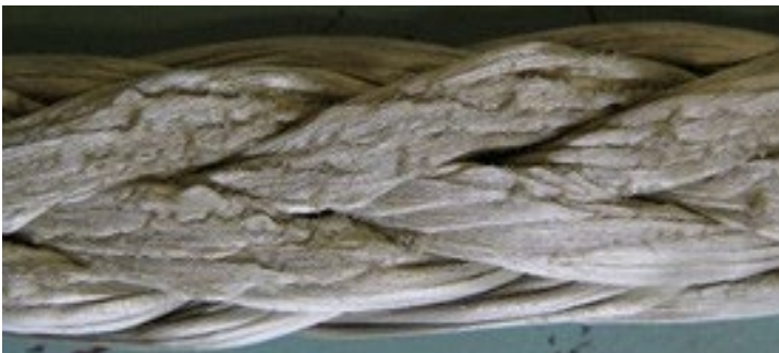
Abb. 14: Beispiel für Hitzeschaden – geschmolzene Fasern
