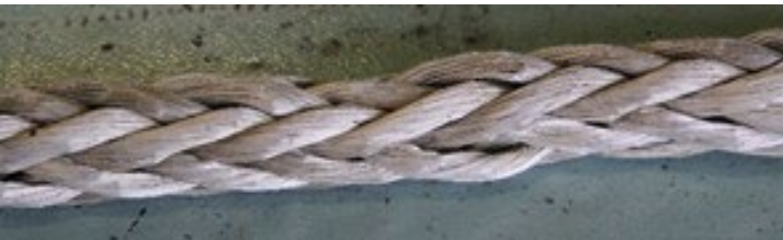
Abb. 13: Beispiel für eine ungleichmäßige Verformung
