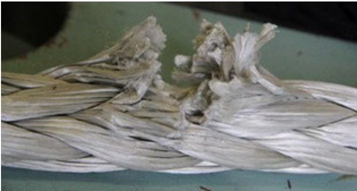
Abb. 10: Beispiel für durchtrennte Litzen
