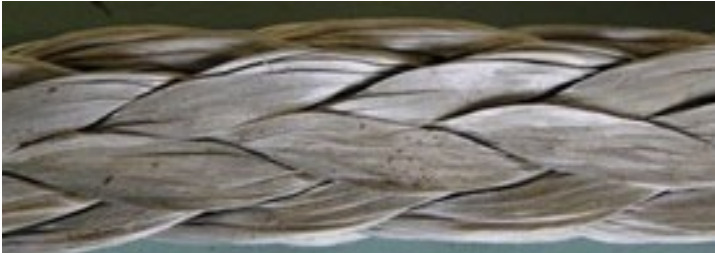
Abb. 15: Beispiel für Hitzeschaden – glasierte Fasern
