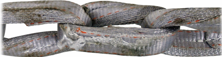
Abb. 3: Abrieb an der Oberfläche des Kettenglieds
