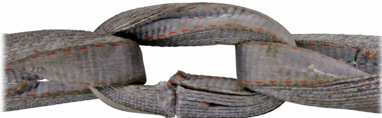
Abb. 4: Einschnitt im Kettenglied
