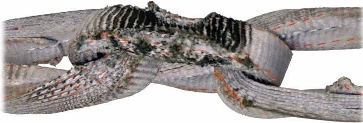
Abb. 6: Gewebeschäden durch Wärmeeinwirkung
