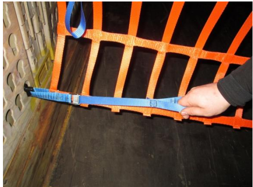
Abb. 13: Die drei Spannelemente mit Hilfe der Handschlaufe anziehen. Anschließend ist die Ladung Rückwärtig normkonform gesichert
