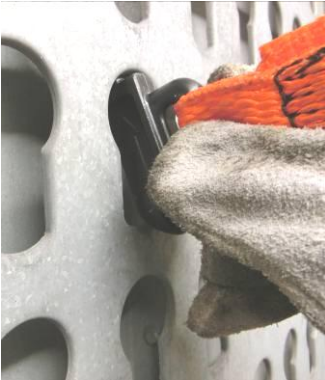
Abb. 7: Den Fitting gerade in das Schlüssellochprofil ausrichten
