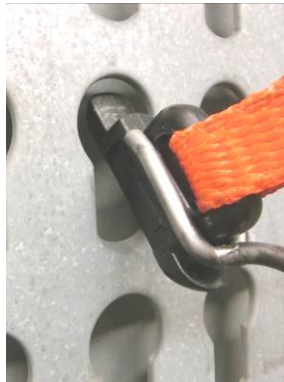
Abb. 16-17: Für den Überkopfeinsatz kann die Montagehilfe verwendet werden. Dazu Fitting auf die Montagehilfe stecken.
