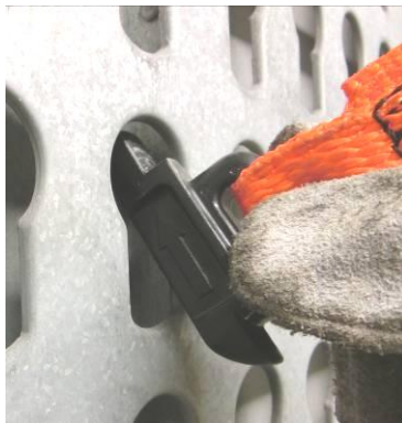
Abb. 6: Den Fitting schräg in das Schlüssellochprofil einführen
