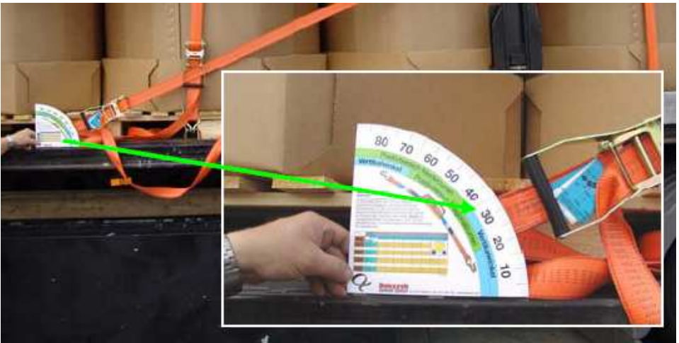
Abb. 8: Berücksichtigung des Zurrwinkel \alpha von ca. 30°
